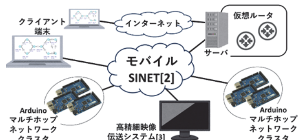
図 3 ネットワークの全体構成図
