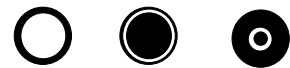
(a)明視野 (b)暗視野 (c)位相差 図 2 疑似撮像用の遮蔽板
