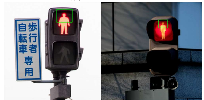
図 2. LED 式(左)と電球式(右)の赤信号認識の様子
